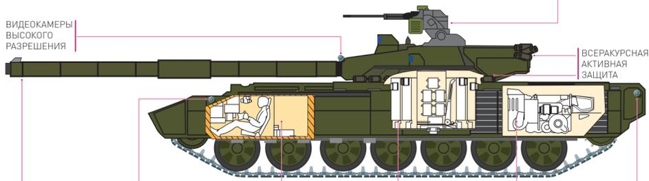
ВИДЕОКАМЕРЫ ВЫСОКОГО РАЗРЕШЕНИЯ, ВСЕРАКУРСНАЯ АКТИВНАЯ ЗАЩИТА, БОЕПРИПАСНЫЙ ОТСЕК С ЭЛЕМЕНТАМИ АВТОМАТА ЗАРЯЖАНИЯ, МТО И ДВИГАТЕЛЬ МОЩНОСТЬЮ 1500 Л.С., ВИДЕОКАМЕРЫ ВЫСОКОГО РАЗРЕШЕНИЯ
